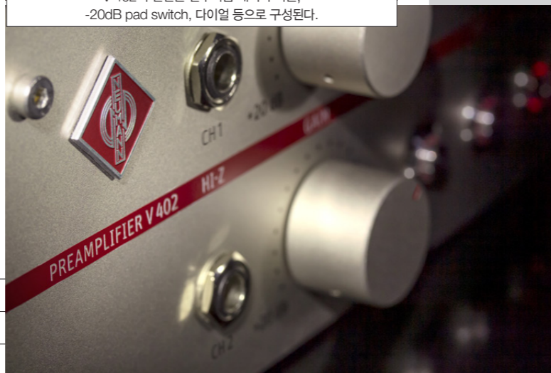
V 402의 전면은 알루미늄 새시와 버튼, -20dB pad switch, 다이얼 등으로 구성된다.
